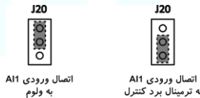
شکل ۶-۳ وضعیت جامپر J20 برای استفاده از ولوم
